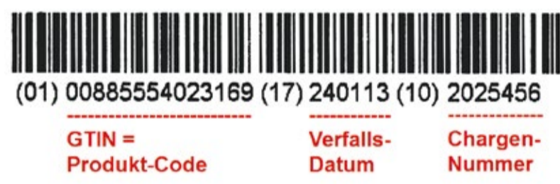
„Kombinierter GSI-Barcode. Der Datenbezeichner in ( ) codiert jeweils die Art der darauf folgenden Information: (01) = GTIN, (10) = Chargen-Nr., (17) = Verfallsdatum.“
